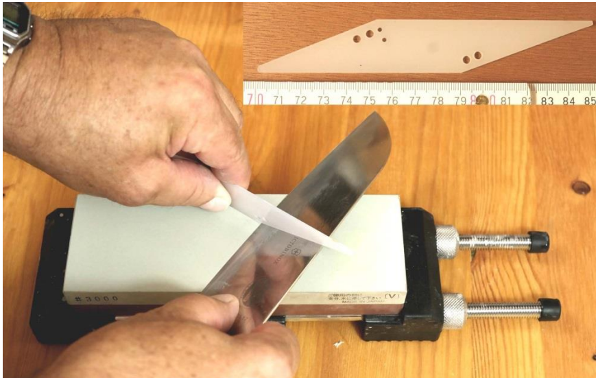
Bild 15: Anwendung einer Winkellehre zum Schleifen der Schneidfassen
