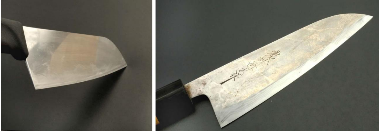
Bild 7: Klingen mit Keilprofil und angeschliffenen Profilfasen) links: Santoku, rostfrei, Keilprofil, nach ca. 10 Schärfvorgängen rechts: Santoku, nicht rostfrei, ebenfalls ursprünglich mit Keilprofil, nach etlichen Jahren Gebrauch und regelmäßigem Schärfen
