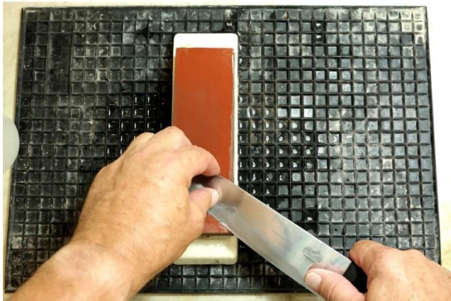
Bild 17: Halten des Messers und Schleifbewegung beim Schleifen der Schneidfase „gegen die Schneide“, rechte Klingenseite
